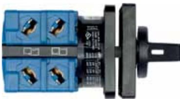
В исполнении E крепление переключателя происходит на лицевой панели четырьмя винтами. Исключением являются малогабаритные переключатели, которые монтируются двумя винтами. Переключатель в исполнении EF имеет пылевлагозащиту спереди IP 66. В исполнении «E...-V» контактная группа повернута на 90° по часовой стрелке. Переключатель в исполнении ER/ERF устанавливается на лицевой панели четырьмя винтами. К переключателю прилагается дополнительная установочная панель для основания.
