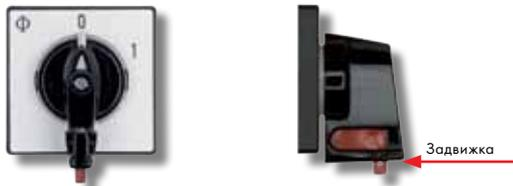
С помощью устройства возможно заблокировать ручку переключателя в положении «Выкл» на 2 висячих замка. Блокировочное устройство в виде задвижки доступно внизу (типоразмер S0 + S1)
