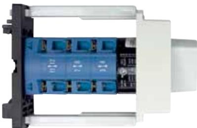
Переключатель в исполнении VE21 крепится на стандартную DIN-рейку (35 мм) согласно EN60715. Лицевая панель переключателя подходит для распределительных щитов со стандартным 45 мм DIN-отверстием. Глубину установки можно регулировать. Пылевлагозащита переключателя спереди IP 40.
