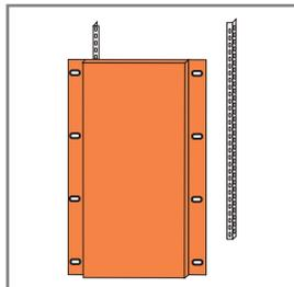
Возможность для стыковки колонн в 1 ряд и тыльными сторонами с помощью уголка крепятся также торцевые панели, задняя стенка, крыша, рым-болты.
