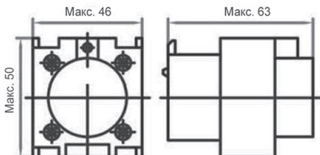
Размеры совместного применения приставки выдержки времени серии ПВЛ-02 с контакторами представлены в руководстве по эксплуатации к контакторам КМ-102.
