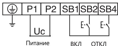
Для подключения МП-338Е воспользуйтесь клеммами 33#, 34# и 35#. Подробнее см. в разделе «Схемы подключения ВА-338Е» (вспомогательные цепи).
