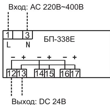
Для подключения БП-338Е к автоматическому выключателю воспользуйтесь клеммами 1# и 2#. Подробнее см. в разделе «Схемы подключения ВА-338Е» (вспомогательные цепи).
