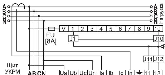
J1, J10 – клеммы подключения катушки контактора.
