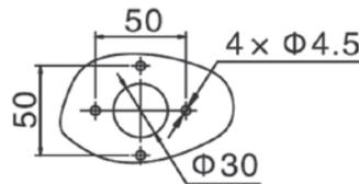
Габаритные и установочные размеры разъединителей ВР-101 125-1600А ЗР(4Р), тип S(WS)
