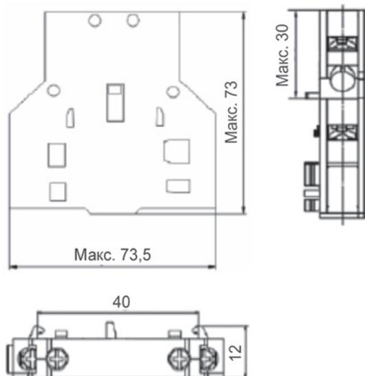
Размеры совместного применения приставки контактной боковой серии ПКБ-02 с контакторами представлены в руководстве по эксплуатации к контакторам КМ-102.
