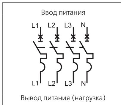
При подключении питания к нижним клеммам автоматического выключателя (ВА-333Е / ВА-335Е / ВА-336Е) необходимо учитывать, что отключающая способность  $I_{cu}/I_{cs}$  снижается на 50%.
