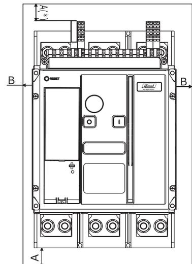
Шаблон для разметки монтажных отверстий
