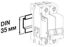
Крепление на DIN-рейку шириной 35 мм
