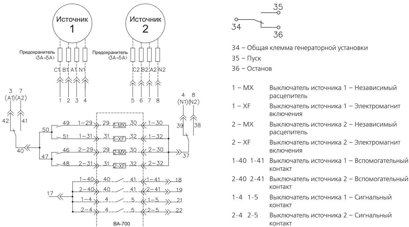
Автоматический ввод резерва на 2 ввода с секционированием
