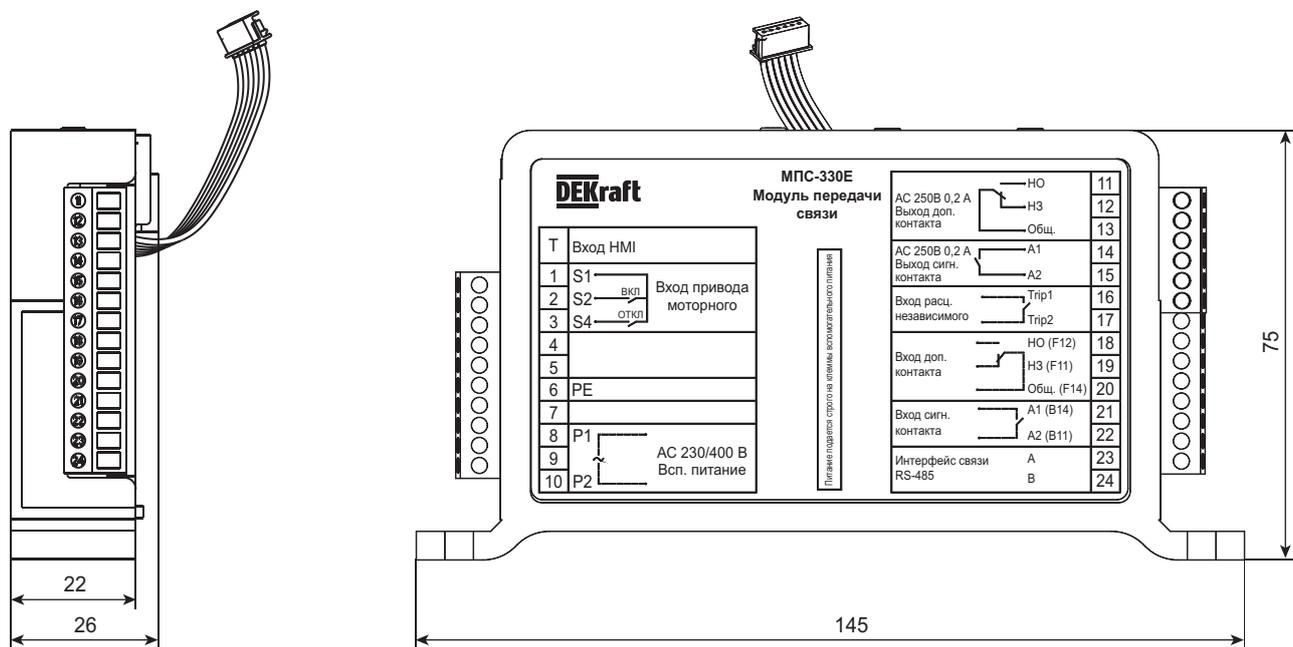
Размеры автоматического выключателя ВА-330Е с установленным модулем передачи связи МПС-330Е
