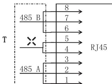
При наличии режима фиксированной адресации можно подключить панель НМИ на дверце шкафа к модулю связи через интерфейс связи #Т для обмена данными между панелью и модулем передачи связи.
