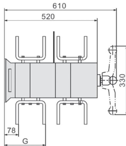
Установочные размеры гнезда ручки на дверь шкафа
