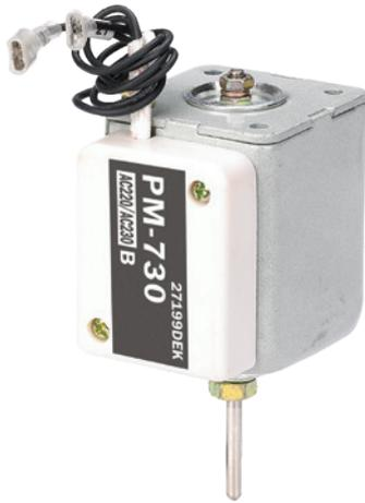
Аксессуар, который служит для отключения автоматического выключателя при снижении напряжения ниже минимального значения. Когда автоматический выключатель включен и его напряжение падает до 70–35 % от номинального напряжения, он может отключиться посредством активации расцепителя. Автоматический выключатель может быть снова замкнут только тогда, когда напряжение питания катушки расцепителя минимального напряжения восстановится до 85 % от номинального напряжения.
