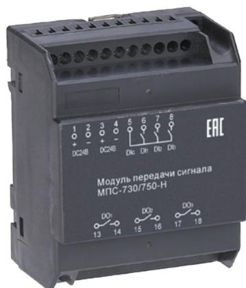
Блок выходных сигналов используется для реализации функций связи по протоколу, либо для аварийной сигнализации или индикации неисправностей. Доступна только работа с блоком управления Н.
