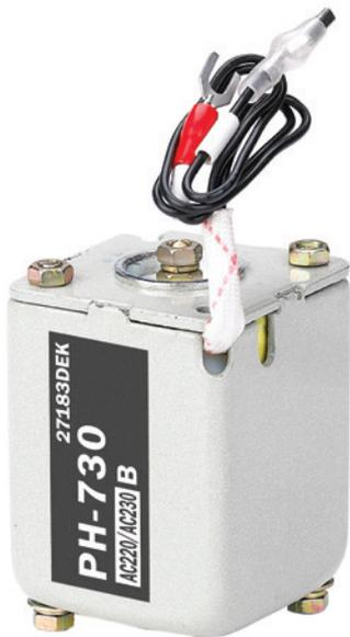
Аксессуар, который служит для дистанционного отключения автоматического выключателя. После аккумулярования энергии в автоматическом выключателе катушка независимого расцепителя немедленно отключит автоматический выключатель при указанном напряжении питания, которым можно управлять дистанционно.
