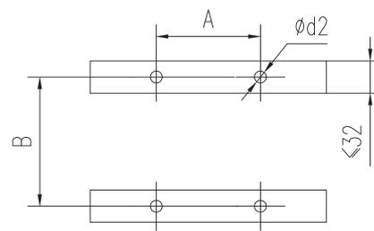
Габаритные размеры выкатного присоединения, мм
