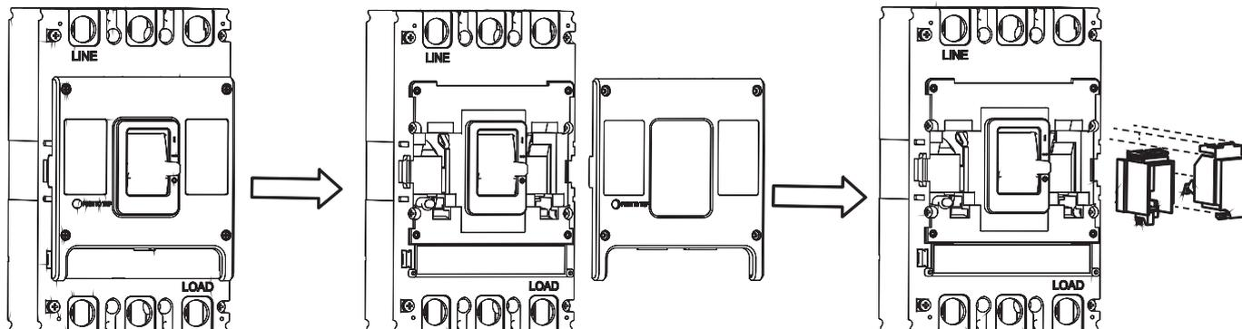
Снимите верхнюю крышку, закрепите аксессуары, которые необходимо установить, в камере для вспомогательных принадлежностей средней крышки и прижмите их. Закройте верхнюю крышку, затяните винт, после чего установка внутренних вспомогательных принадлежностей будет завершена. В левую и правую камеры средней крышки можно установить по одному аксессуару.
