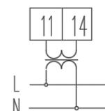
Подключение цепей напряжения (через трансформатор напряжения – выше AC 600 В)
