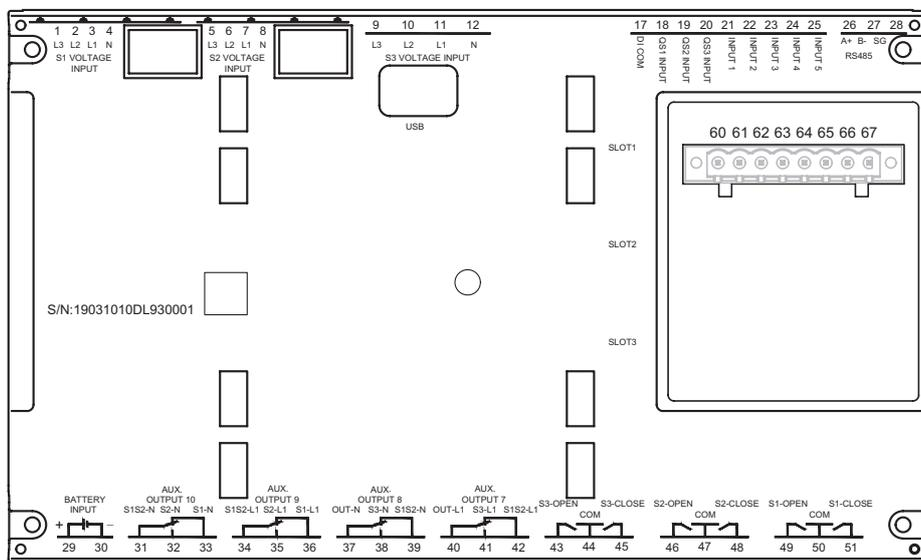
Электрическая схема подключения АВР-701-3
