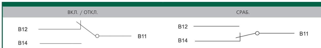
Для подключения СК автоматического выключателя ВА-338Е воспользуйтесь клеммами 3#, 4# и 5#. Подробнее см. в разделе «Схемы подключения ВА-338Е» (вспомогательные цепи).
