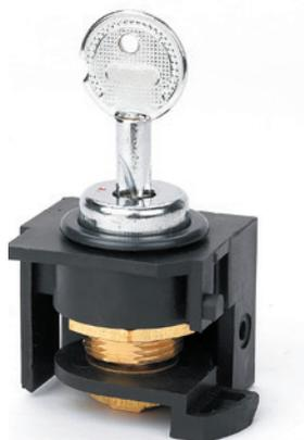
Когда автоматический выключатель находится в отсоединенном положении, его можно заблокировать от включения с помощью замка с ключом. В этом случае автоматический выключатель может быть включен только тогда, когда замок открыт ключом и ключ не вынут из замочной скважины. Существует три варианта такого способа блокировки (последние два используются в распределительной системе с двумя линиями и одним соединительным интерфейсом): один замок, один ключ; два замка, один ключ; три замка, два ключа.
