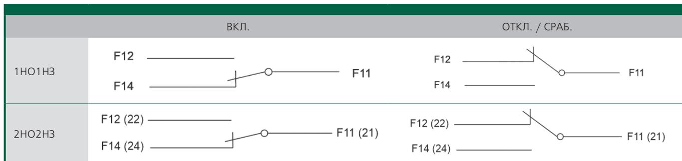
Для подключения ДК автоматического выключателя ВА-338Е воспользуйтесь клеммами 36#...47#. Подробнее см. в разделе «Схемы подключения ВА-338Е» (вспомогательные цепи).
