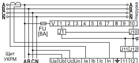
J1, J10 – клеммы подключения катушки контактора.
