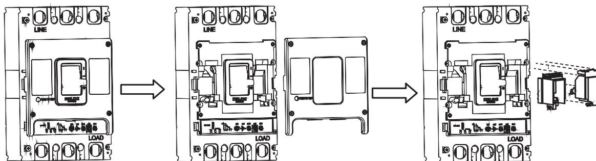
Снимите верхнюю крышку, закрепите аксессуары, которые необходимо установить, в камере для вспомогательных принадлежностей средней крышки и прижмите их. Закройте верхнюю крышку, затяните винт, после чего установка внутренних вспомогательных принадлежностей будет завершена. В левую и правую камеры средней крышки можно установить по одному аксессуару.
