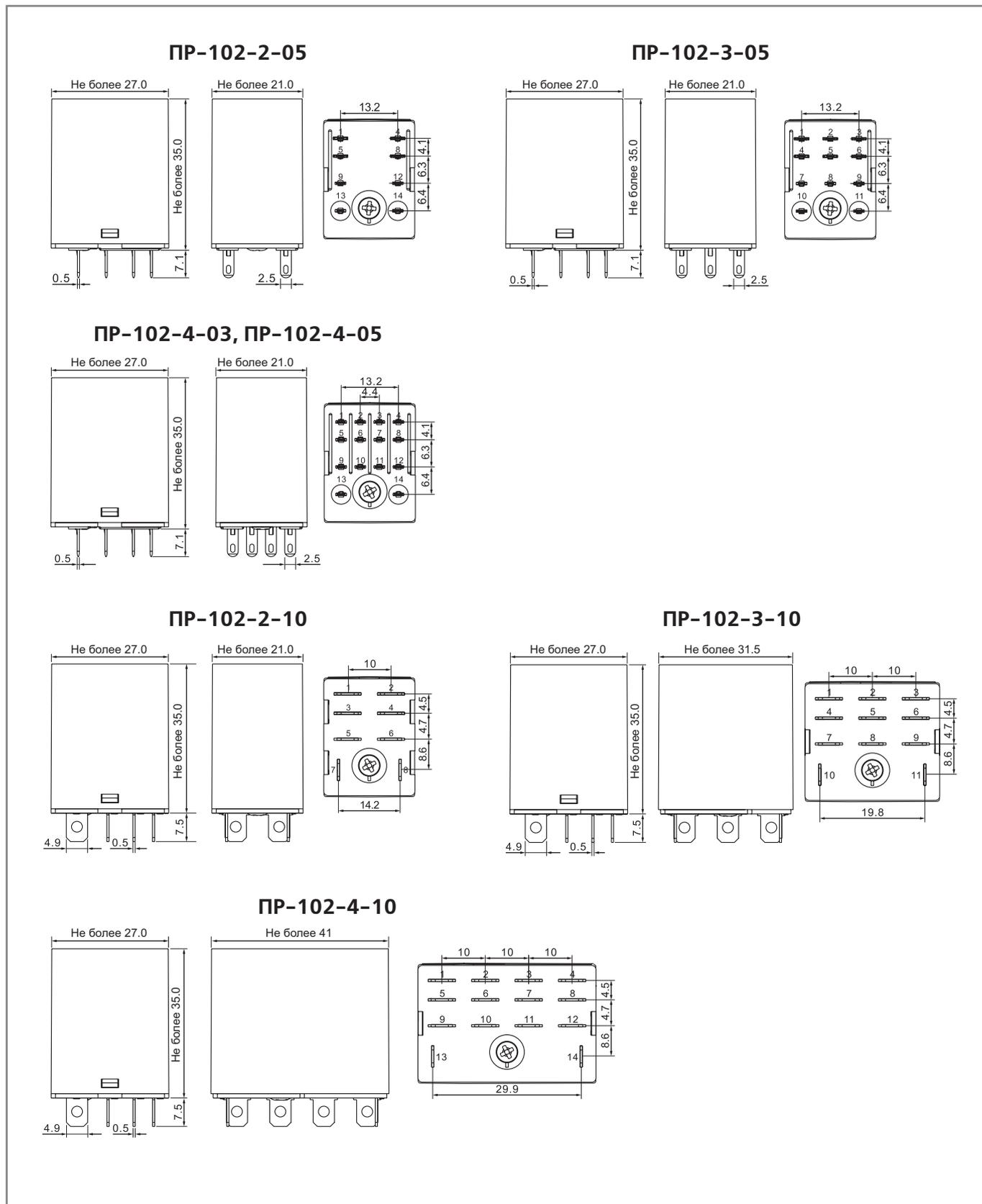
Габаритные и установочные размеры разъемов для крепления на DIN-рейку реле промежуточных серии PP-102
