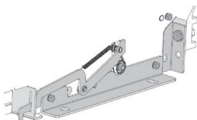
У выкатного автоматического выключателя ответная часть механизма запирания дверцы распределительного шкафа установлена на боковой стороне выключателя. Механизм запирания дверцы гарантирует, что она не откроется, когда автоматический выключатель находится в положении Connection (Соединение) и Test (Тест). В положении Switch-off (Отключен) дверца распределительного шкафа может быть открыта.
