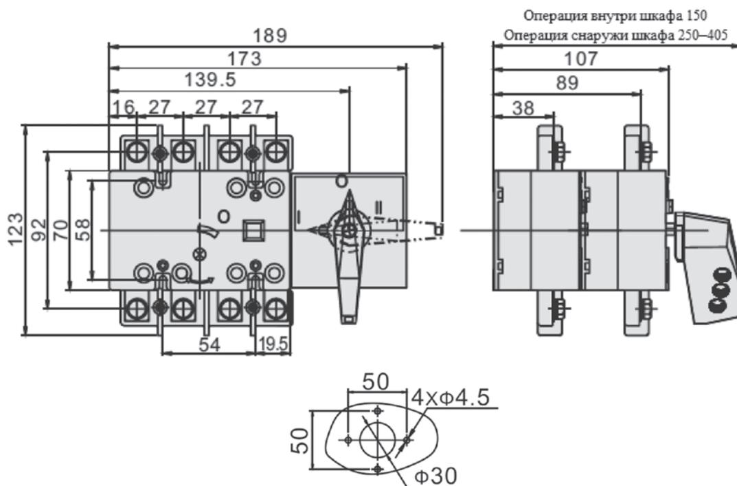
Габаритные и установочные размеры разъединителей ВР-101 125-1600А ЗР(4Р), тип Т(WT)
