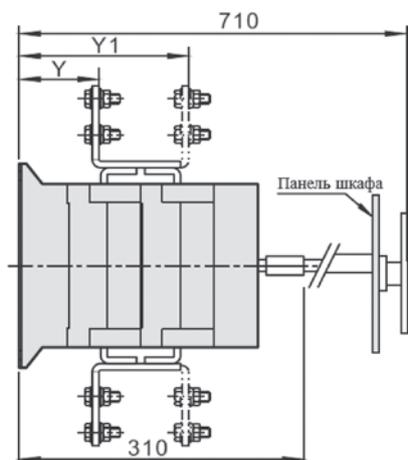
Установочные размеры гнезда ручки на дверь шкафа
