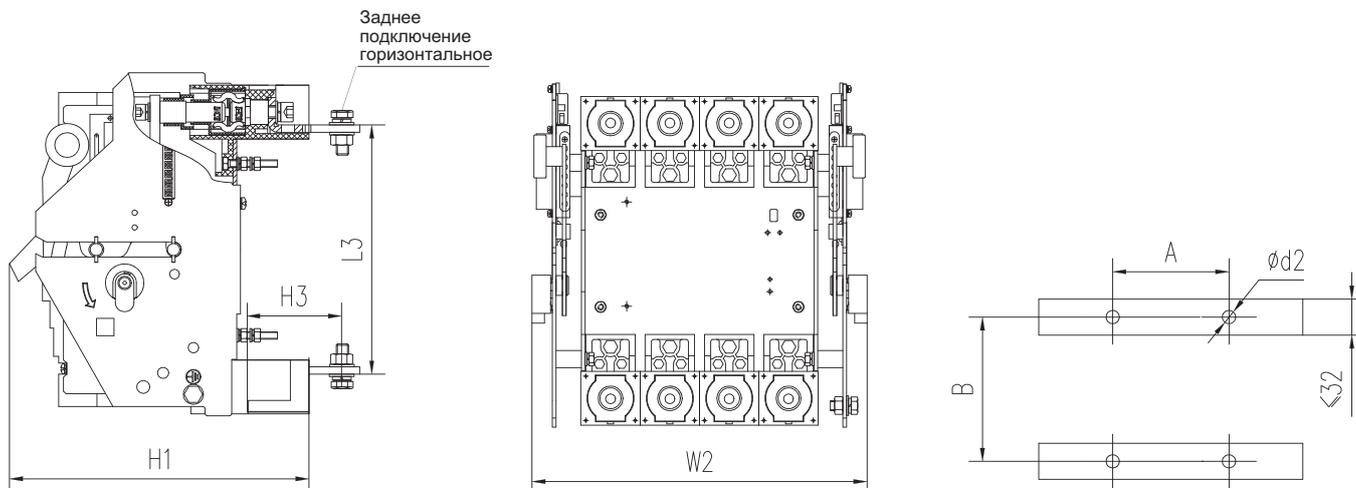
Габаритные и установочные размеры корзины выкатного типа
