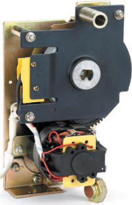
Мотор-редуктор аккумулирует электроэнергию для срабатывания автоматического выключателя в обесточенном состоянии. Накопленной энергии достаточно, чтобы отключить или включить автоматический выключатель при срабатывании независимого расцепителя, расцепителя минимального напряжения и замыкающего электромагнита. Когда нет доступных источников питания, электроэнергия может быть аккумулирована в автоматическом выключателе с помощью рукоятки механизма.
