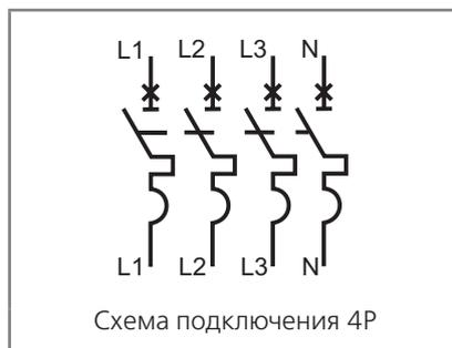
При подключении питания к нижним клеммам автоматического выключателя ВА-300, ВА-300М необходимо учитывать, что отключающая способность  $I_{cu}/I_{cs}$  снижается на 50%.
