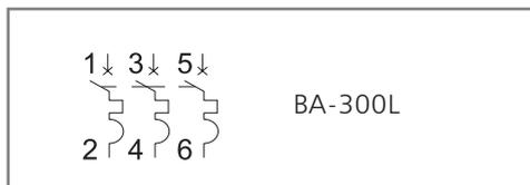
При подключении питания к нижним клеммам автоматического выключателя BA-300L необходимо учитывать, что отключающая способность  $I_{cu}/I_{cs}$  снижается на 50%.
