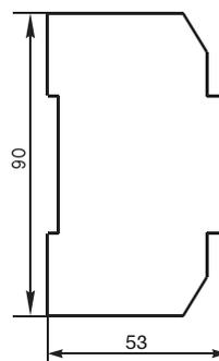
Блок питания БП-338 может быть установлен на DIN-рейку шириной 35 мм.
