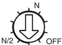
«OFF»: отключение функции защиты нейтрали, которая используется в распределительных сетях, не требующих защиты нейтрального полюса.
