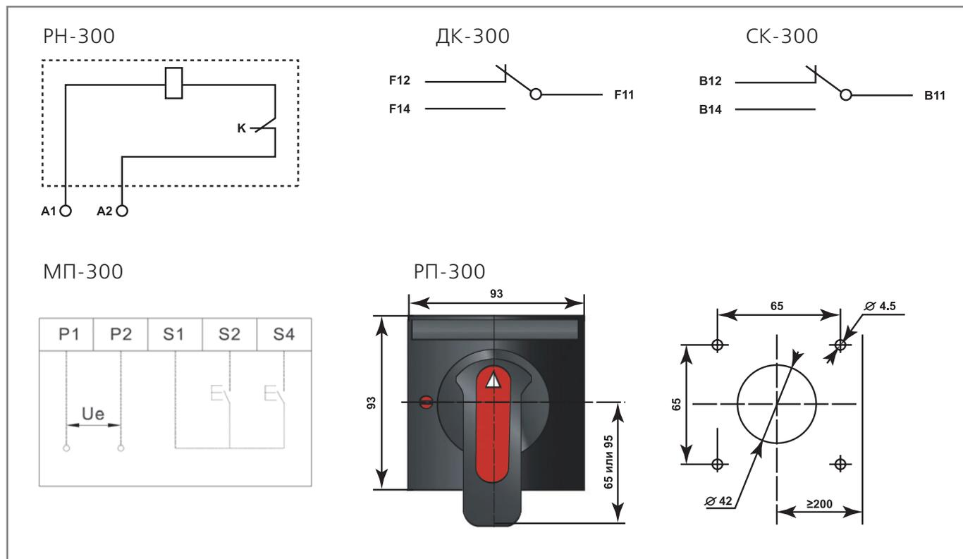
Габаритные размеры МП-300, мм
