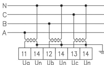
Подключение цепей напряжения (через трансформатор напряжения – выше AC 600 В)
