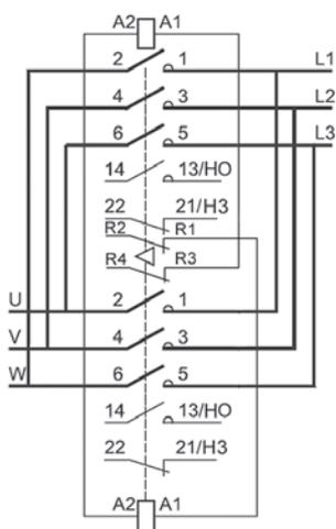
KM-103 9-95A (горизонтальное подключение, механическая + электрическая блокировка)
