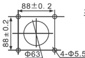
Установочные размеры гнезда ручки на дверь шкафа типа В
