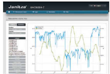
Рис.: Отображение оперативных данных через собственную Интернет-страницу устройства
