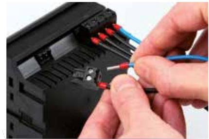
Рис.: Вставные клеммы с винтовым зажимом
