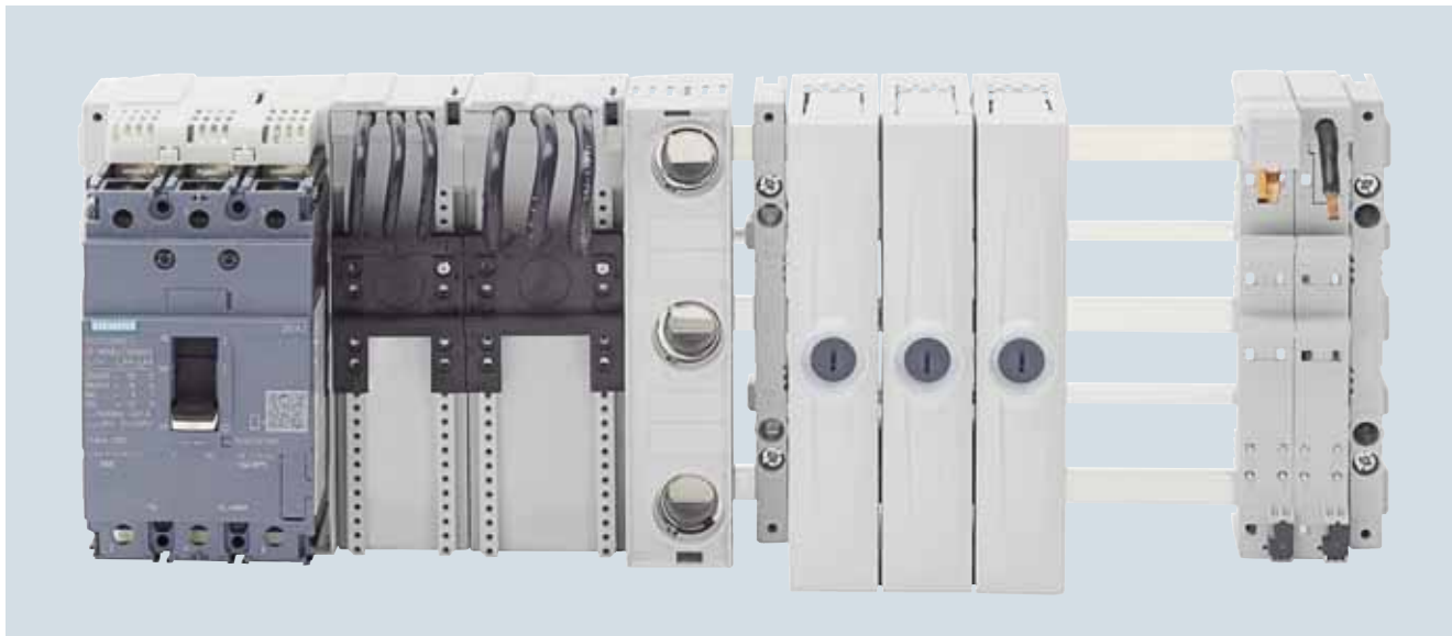
Компактная система сборных шин 60 мм 3- и 5-полюсного исполнения для нижнего рабочего диапазона до 360 А: вводы питания и устройства подключения
