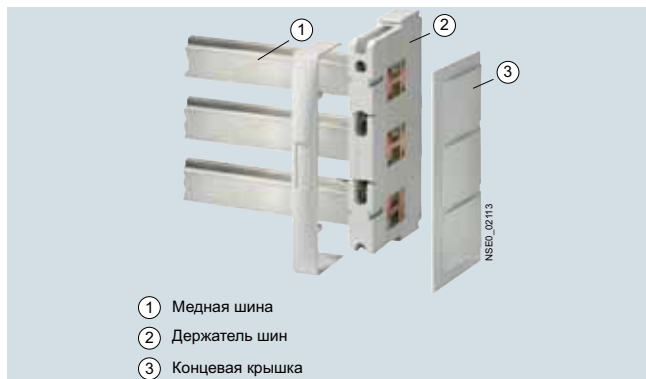
Система сборных шин 60 мм: базовая компоновка до 1600 А
