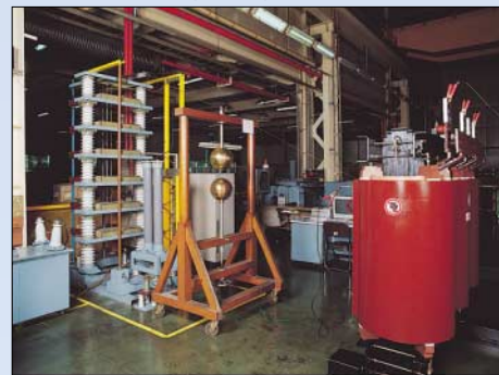
Испытание на устойчивость к импульсным перенапряжениям
