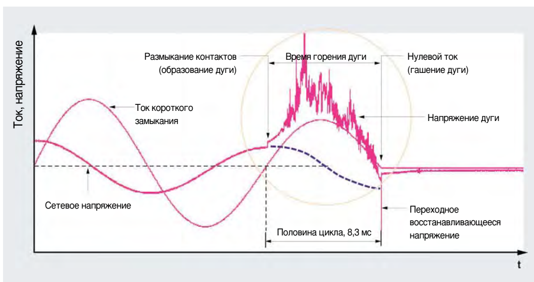
Пример осциллограммы, полученной при коммутационном испытании с использованием резонансного LC-контура
