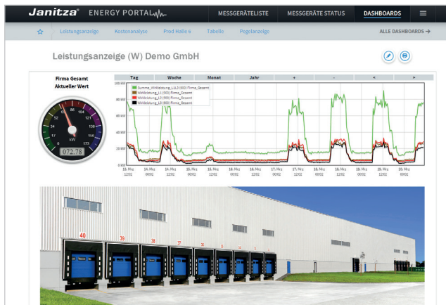
Рис.: Пример панели управления с линейной диаграммой (профиль нагрузки) и значением мощности, отображаемым с помощью дисплея аналогового указателя.
