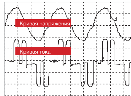
Рис.: Обратные воздействия на сеть, вызванные преобразователями частоты
