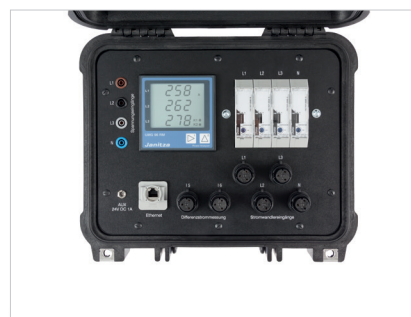
Рис.: MRG 96RM-E RCM Flex - Портативный прибор для измерения энергии с измерением дифференциального тока-RCM (Аналогичное изображение)
