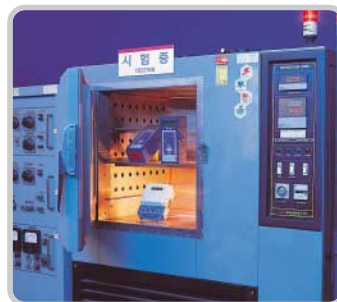
Испытание непрерывным воздействием высокой температуры
