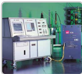
Проверка характеристик вакуумного автоматического выключателя
