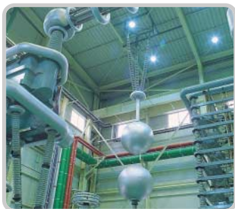
Испытание импульсом в лаборатории высоких напряжений
